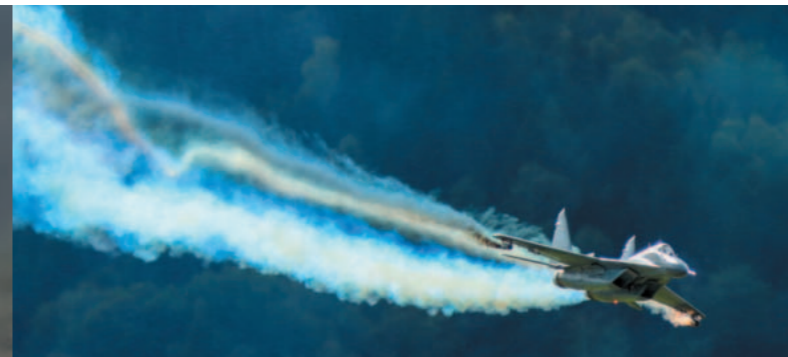
Eindrucksvoll in Szene setzte Heiko Gärtner seine Mig-29 mit einer Spannweite von 2.600 mm, die von zwei Jetcat P100 angetrieben wird.
