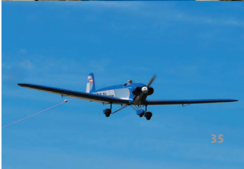
Die neo-Klemm fliegt mit dem Elektro genauso wie seinerzeit mit dem Verbrenner. Der Seitenzug war bei beiden Ausführungen gleich groß – sechseinhalb Grad!
