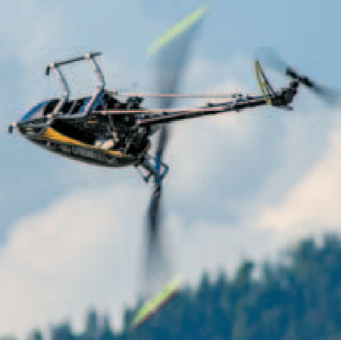
Ein Produkt der Firma ist der Furion 6 Helicopter mit einer Länge von 1.203 mm und einem Rotordurchmesser von 1.365 – 1.405 mm.
