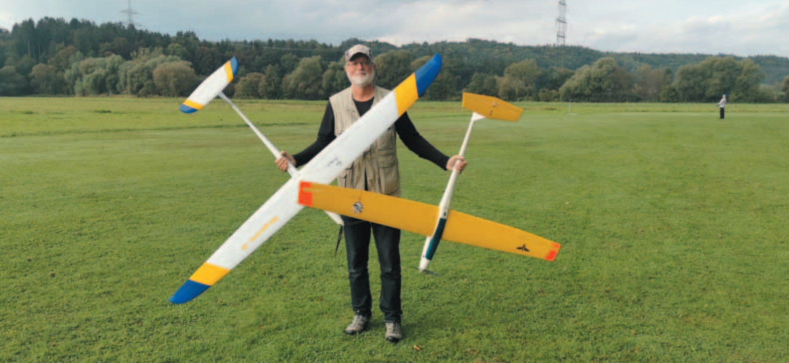
Heimo Stadlbauer mit dem Voll-GfK-F5F-Modell „Surprise XV“ von Rudi Freudenthaler (links) und rechts eine F5F-Eigenkonstruktion aus 1989 „E-Blitz II“ mit beplankten Holzflächen, Bürstenmotor und zehn Stück 2.000 mAh Sanyo Sub-C NiCd-Zellen.
