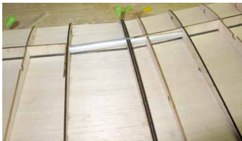
Flächensteckung mit Alurohr und CFK-Stab.
