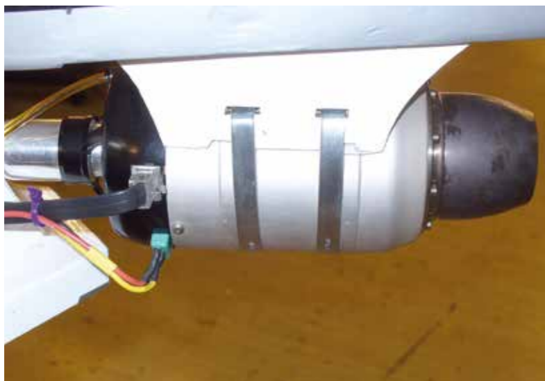
Nach dem Umbau führen nur noch ein Flachbandkabel, das Versorgungskabel für den Starter und Zündung sowie der Kraftstoffschlauch zur Turbine.
