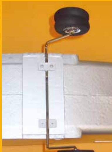
▲ Die Befestigung des Hauptfahrwerks erfolgt mittels zweier Kunststoffplättchen und vier drei Millimeter Schrauben.
