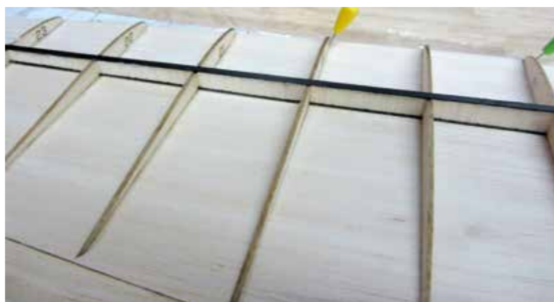
Balsaholm mit CFK Gurtverstärkung.
