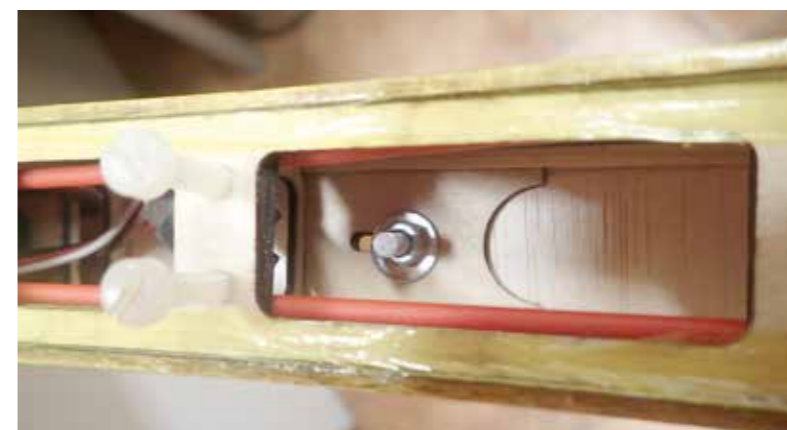
Seglerrumpf mit verschiebbarem Hochstarthaken.
