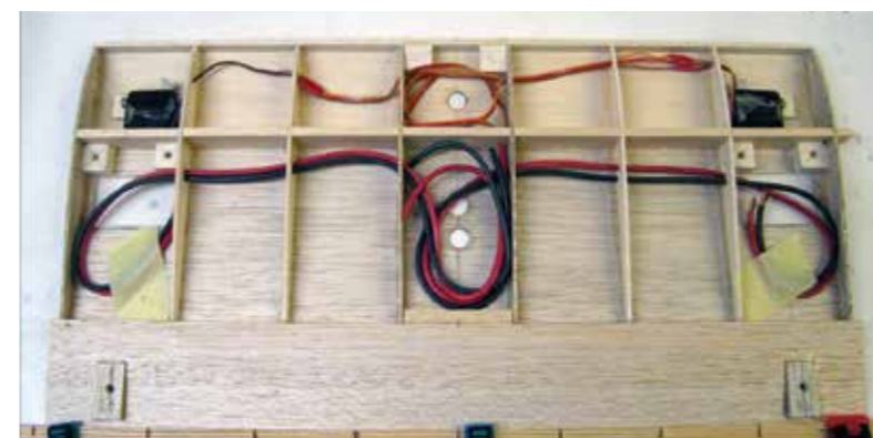
Das Tragflächenmittelstück mit bereits verlegten Kabelbäumen.
