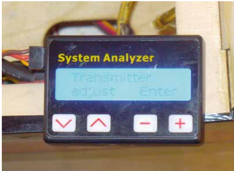
Mit dem neuen Terminal kann die Einstellung des Senderwegs komfortabel und direkt durchgeführt werden.
