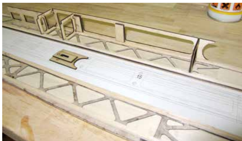
Aufbau Kastenrumpf E-Segler.
