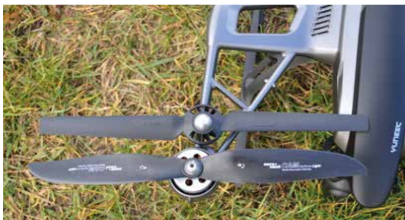
Die Aeronaut Cam carbon light Luftschaube im Vergleich mit der Original-Luftschaube.
