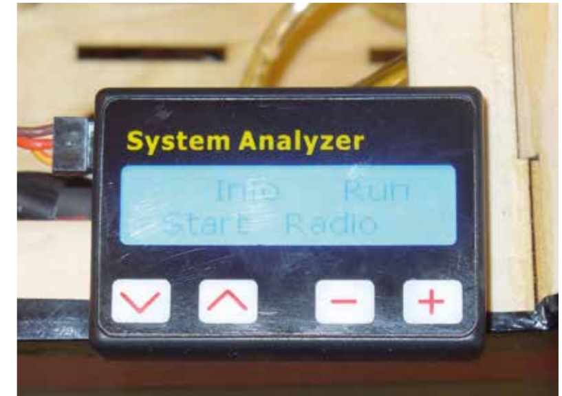
Mit Hilfe des Eingabeterminals können sämtliche Parameter der Turbine individuell eingestellt werden. Die genaue Beschreibung dazu findet man auf der Homepage der Fa. XICOY.
