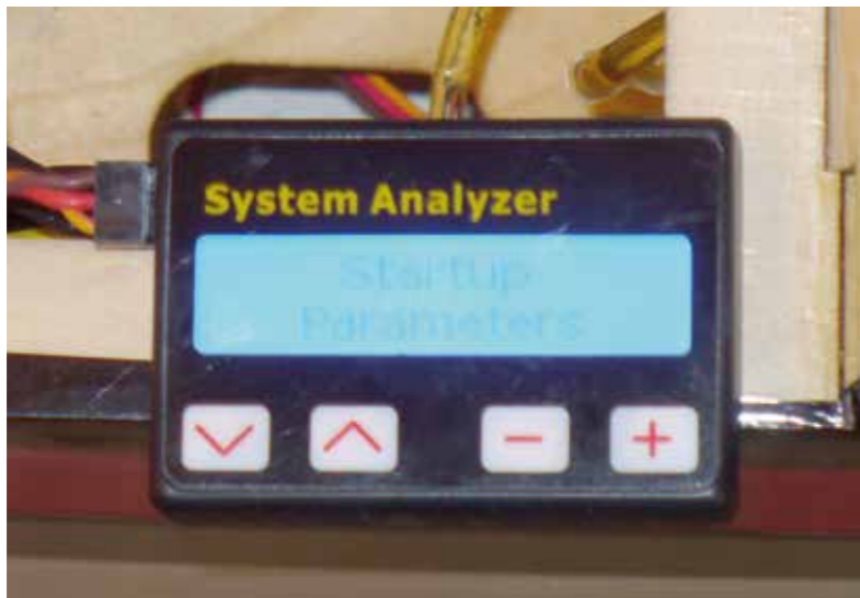
Durch Drücken der zweiten Pfeiltaste von links gelangt man in das Startup-Menü.
