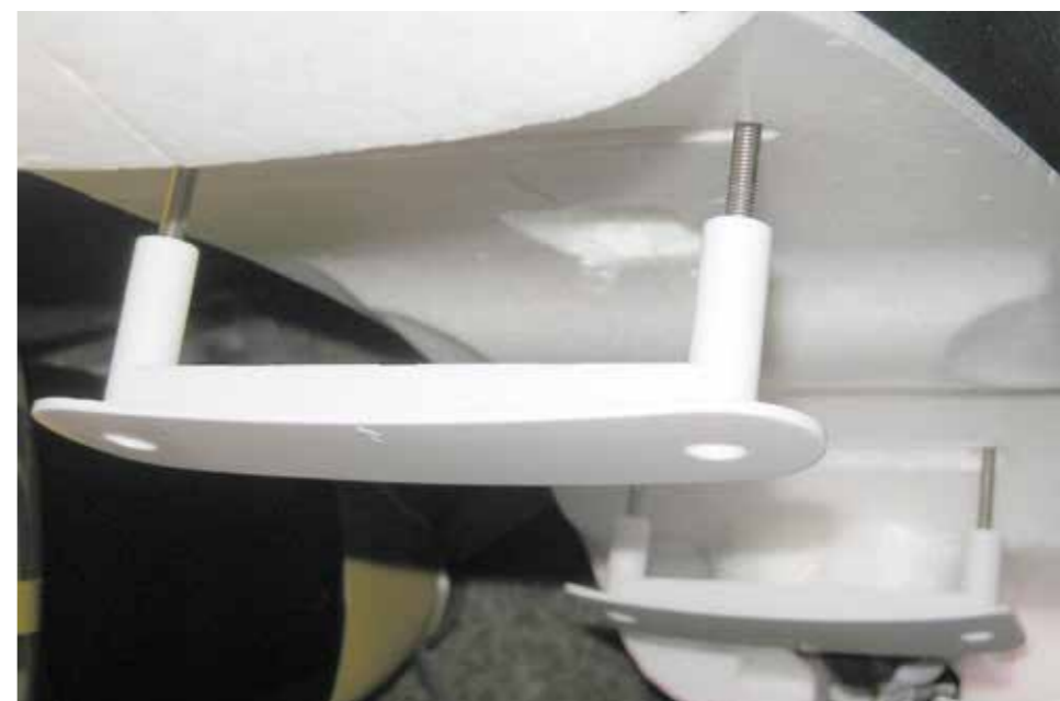
Die Tragflächen werden mit vier 5-mm-Stahlschrauben und diesen Kunststoffflaschen am Rumpf befestigt.
