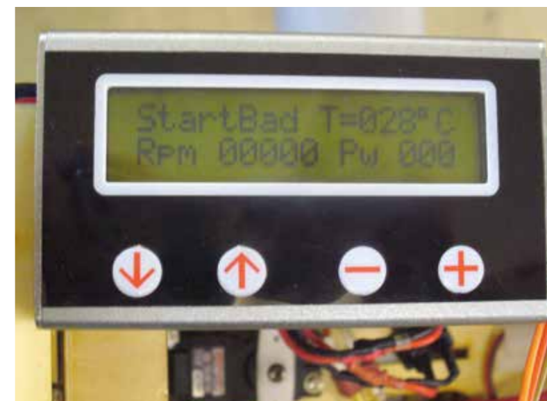
Die ersten Tests endeten mit der Anzeige am Terminal „Start Bad“ – die Turbine lief nicht an.
