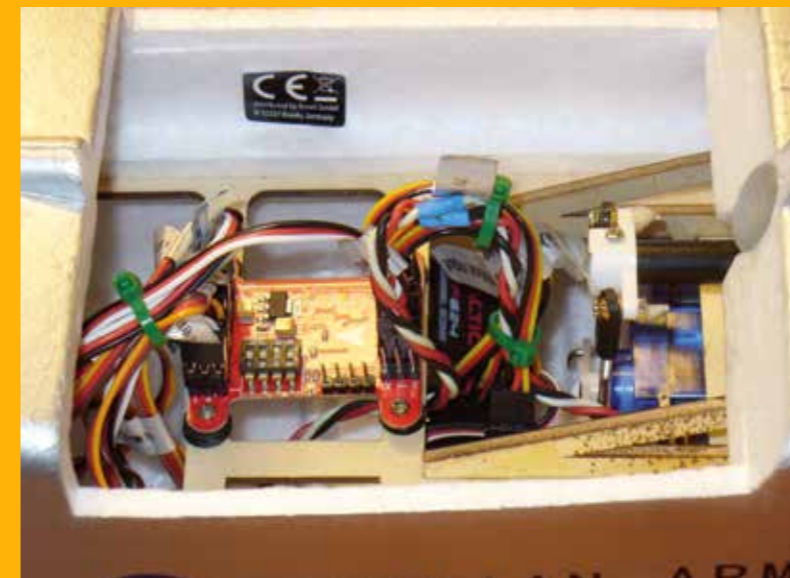
Blick in den rückwertigen Techniraum, wo die Stabilisierungselektronik, der Empfänger und die Anlenkung des Heckmotors untergebracht sind.
