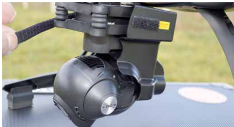
Der Transportschutz der Kamera wird mit einem Klettband gesichert.
