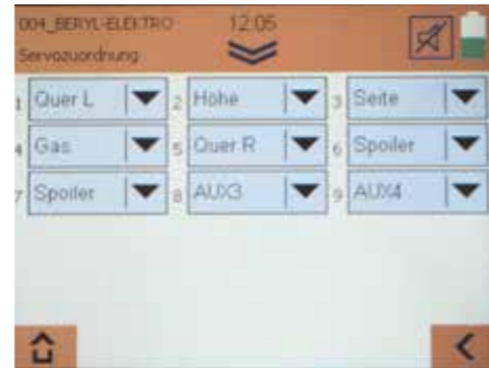
Freie Servo-Zuordnung der neun Kanäle.
