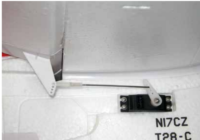
Die Anlenkung der Landeklappen und der Höhenruder ist werkseitig bereits erledigt.
