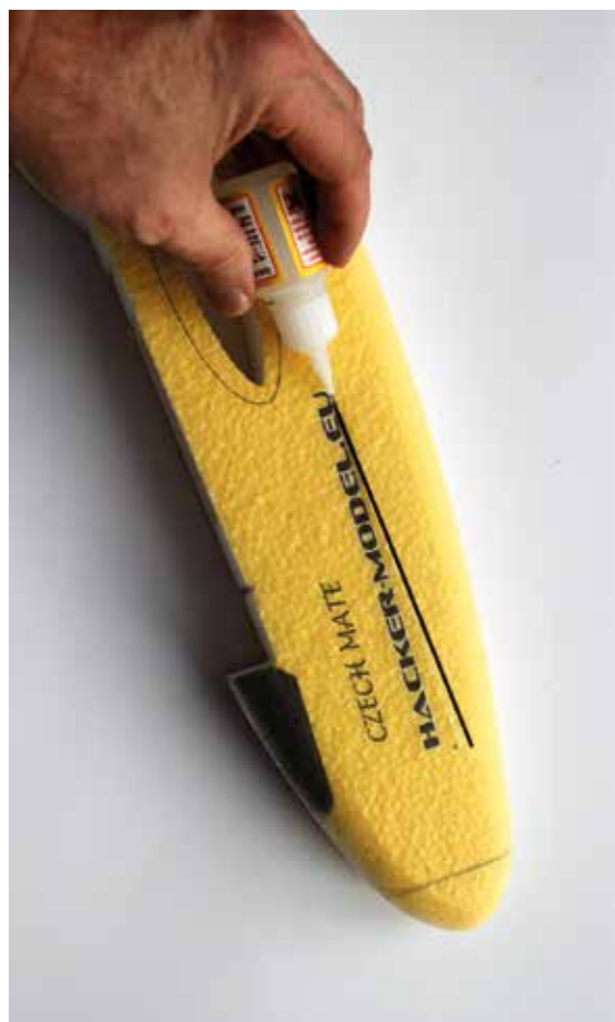
Die Verstärkung des Rumpfes erfolgt durch eingeklebte GfK Stäbe
