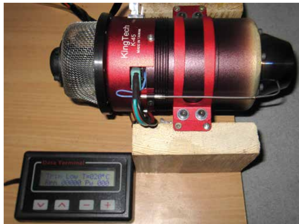
Die King Tech K-45 auf dem Teststand, daneben ist das Data-Terminal zu sehen. Mit dessen Hilfe lassen sich die Parameter der Turbine optimieren.
