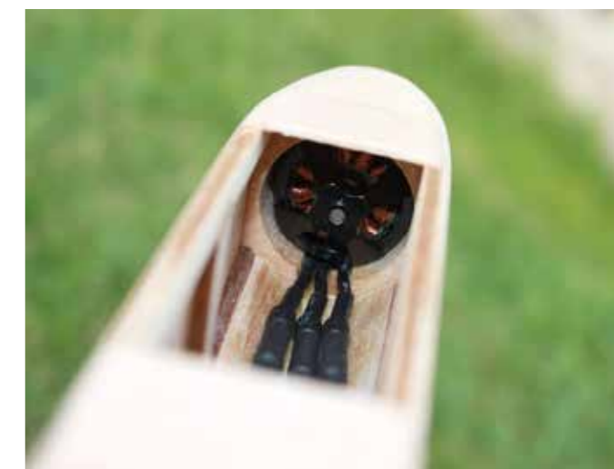
Der sehr knappe Einbau des Motors – etwas Ausschleifen ist sinnvoll.
