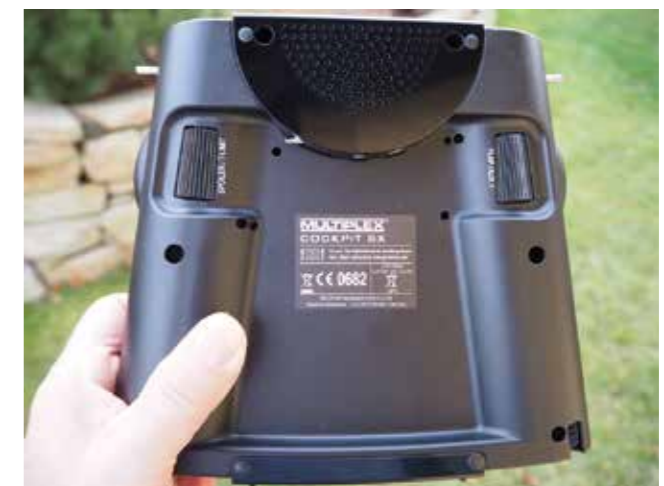
Rückseite mit Lautsprecher, USB-Buchse und Drehgeber.
