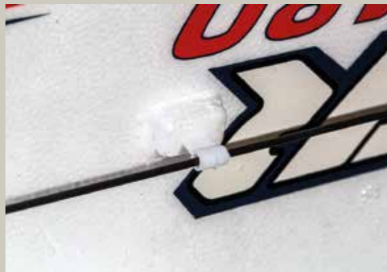
Die Führungen sind bereits fertig. Die Schubstangen laufen darin sehr leichtgängig.
