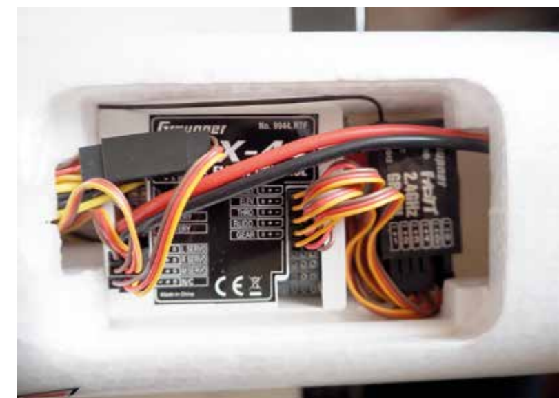
Detail Kreisel mit Mehrfachgyro und HoTT Empfänger.
