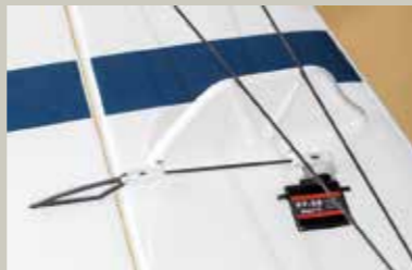
Die Servos sind bereits eingebaut. Die passend abgelängten Ruderanlenkungen und Streben müssen noch angebracht werden.
