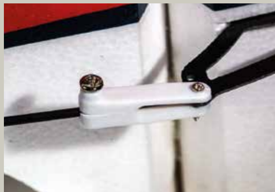
Zwei Schrauben an jedem Gabelkopf: Das hält.
