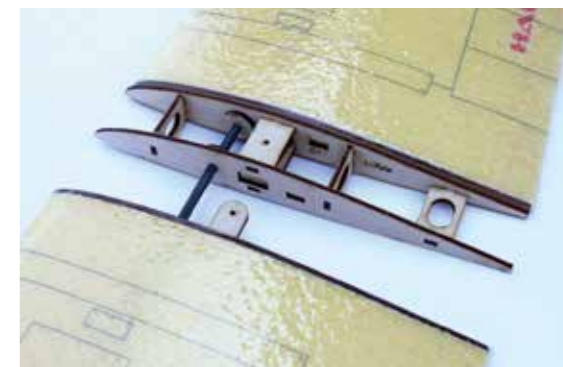
Die Flügelsteckung fertig zusammengebaut mit den Laschen zur Sicherung. Wichtig: den symmetrischen Sitz der Flügel kontrollieren.
