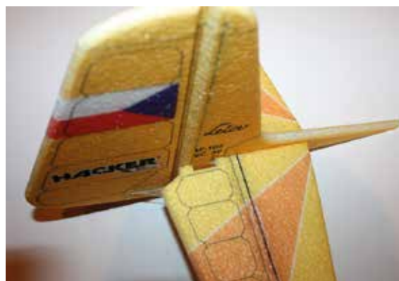
Für die rechtwinkelige Ausrichtung der beiden Leitwerksteile sind kleine Abstandhalter vorhanden.
