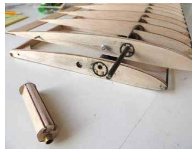
Innovative Cliptechnik für die werkzeuglose und klebstreifenfreie Verbindung der Flügelteile.
