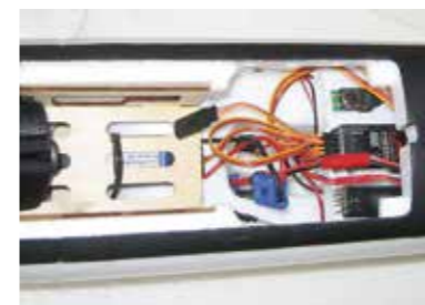
Links vom Empfänger der Taster für die Nachtbeleuchtung. Rechts das Steuergerät für die Beleuchtung.
