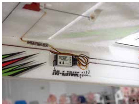
Empfängerfach mit bereits vorgefertigten Schlitzen für die Servo-Kabelführung.
