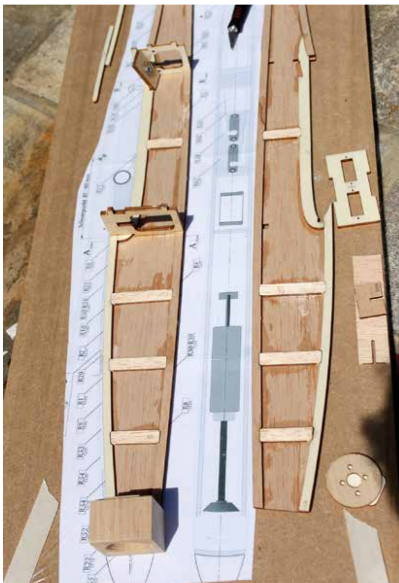
Einbau der Servos für die Landeklappen im Flügelmittelteil.
