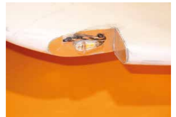
Um die Wirkung der Positionsleuchte zu erhöhen, erfolgte die Verblendung mit 1mm Blechstreifen.
