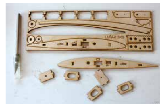
Begonnen wird der Bau mit der Flächenhalterung. Die passgenauen Sperrholzteile werden zu einem Rippenkasten zusammengebaut und dann in den Rumpf eingeklebt.
