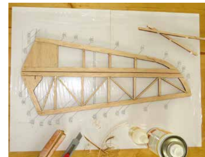
Die Teile für das Höhenleitwerk passen perfekt zusammen.
