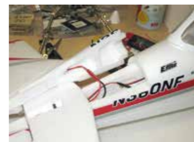
Verkabelung der Leitwerksbeleuchtung.
