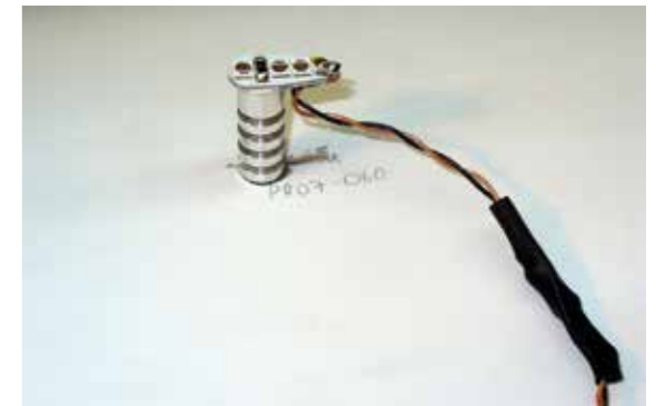
Einbau des ACL-Lichtes (Antikollision) am Rumpfrücken der Boeing 727-200. Der Zylinder unter dem Leuchtmittel sorgt für Wärmeabfuhr.
