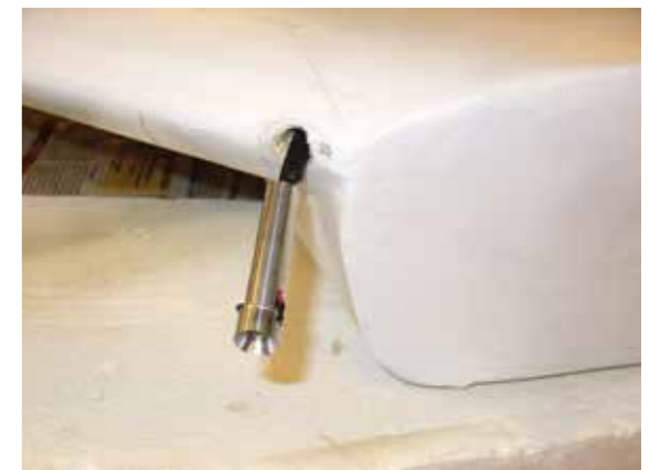
Hier ist der innere Landescheinwerfer vor dem Einbau in der Tragflächenwurzel zu sehen.
