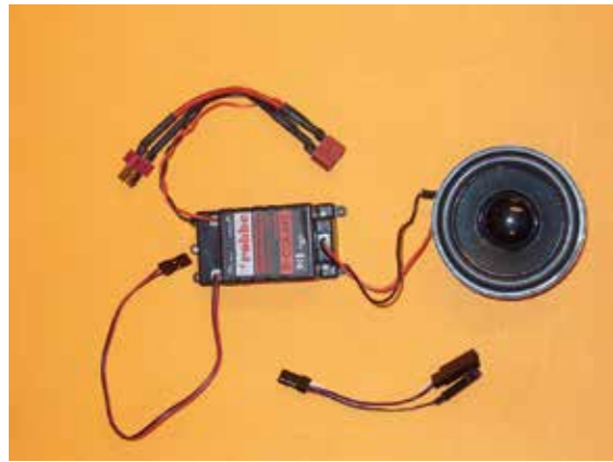
◀ Das Soundsystem besteht aus dem Modul, Lautsprecher und zugehöriger Verkabelung.
