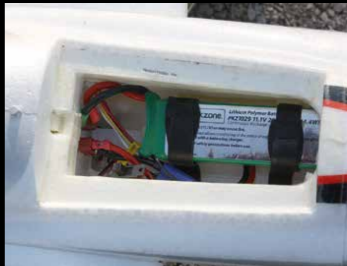
Der 3s-Flugakku findet seinen Platz in einem Fach im vorderen Rumpfbereich. Hier befindet sich auch der Schalter für die Beleuchtung.
