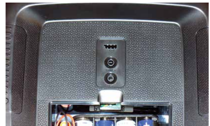
Mit Hilfe des Data-Ports auf der Gehäuse-Rückseite kann die Flash 7 auf die neueste Software upgedatet werden. Gleich daneben befindet sich die Trainer-Buchse sowie ein DCS-Anschluss. Über diesen kann man z.B. eine Videobrille mit Strom aus dem Senderakku versorgen.
