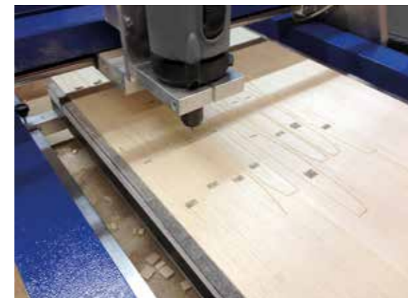
Die Fräsarbeit wurde von mir erledigt, das heißt alle Rippen, Rumpfsseitenteile, Nasenklotz, ja sogar das Servobrett mit Schalter wurden gefräst.
