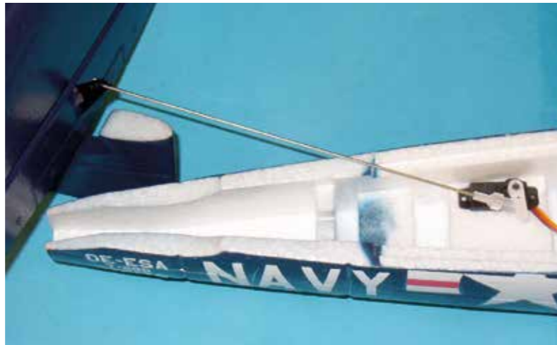
Der Gabelkopf der Höhenrunder-Anlenkung gehört noch in das Rudernhorn einhängt.
