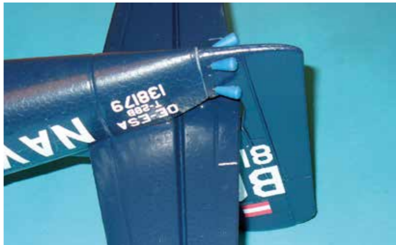
Mittels Stecknadeln wird das rückwärtige Rumpfteil mittels 30-Minuten Epoxydharz verklebt und durch Stecknadeln gesichert.
