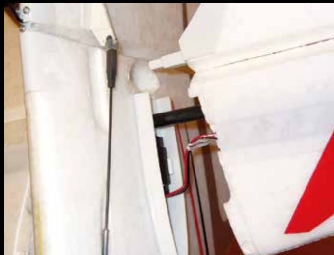
Vor dem Einstecken der beiden Höhenleitwerkshälften, sollte man nicht auf die Steckverbindung für die LED-Beleuchtung vergessen. Gesichert werden die beiden Hälften mittels durchsichtiger Klebestreifen.
