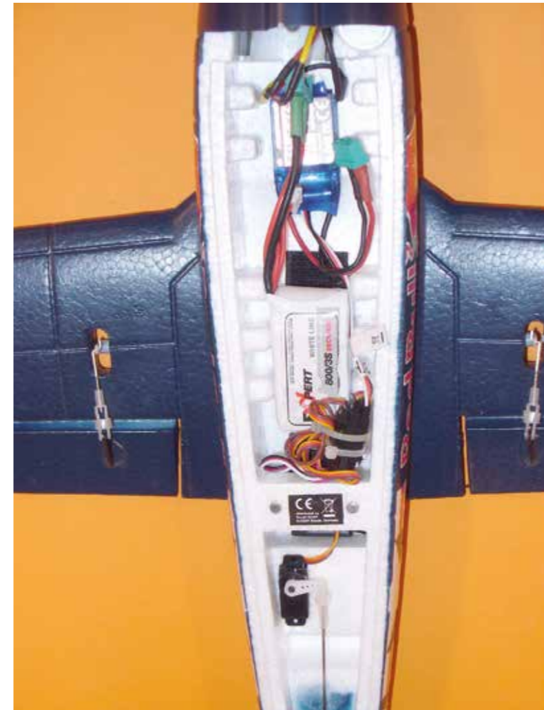
Der Zugang zum Akkufach und Empfänger erfolgt über die obere Rumpfabdeckung, welche in die Motorhaube geschoben und mittels Magneten auf der Unterschale gehalten wird. Das Rumpfinnere bietet genügend Platz für den 3s 850mAh-Akku und Tactic TX624 Empfänger.
