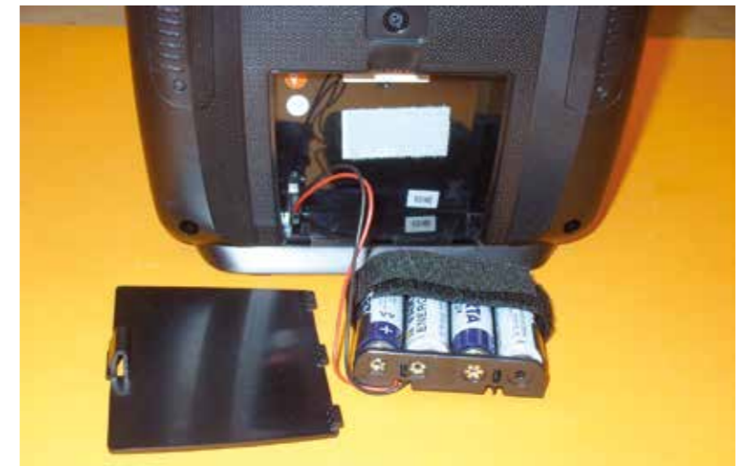
Für die Inbetriebnahme des Flash 7-Senders benötigt man vier Mignonzellen, welche auf der Rückseite in das Batteriefach eingesetzt werden.
