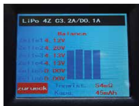
Anzeige Einzelzellen LiPo
