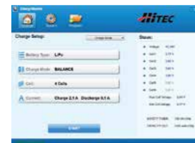
Lade Ende durch Zeitbegrenzung, Zellenspannungsdifferenz 0,15 V max
