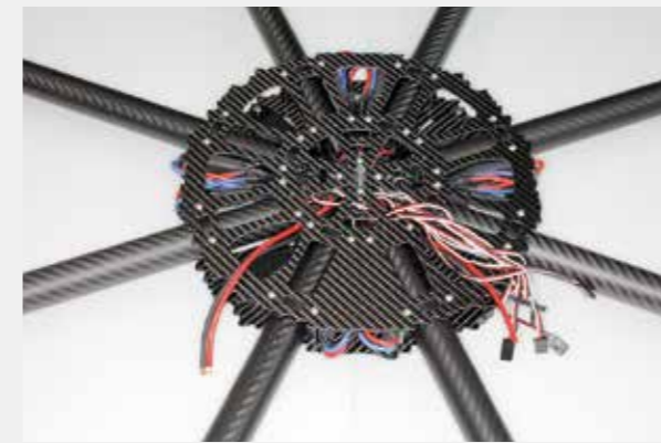
Centerplate mit bls-Controller
