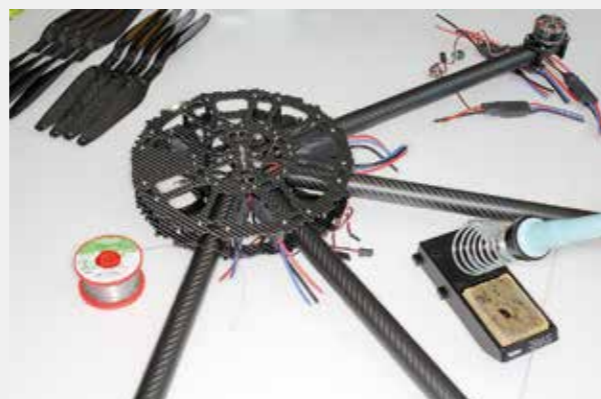
Verlöten der Motoren mit dem bls-controller
