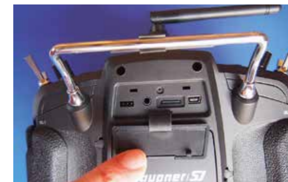
Hinter einer Schutzklappe USB- und Dataanschluss sowie Kopfhörerbuchse und Speicherkarte
