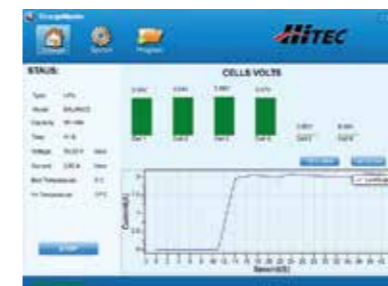
Einstellungen vor Ladestart, Spannungsdifferenz der Einzelzellen 0,17 V max
