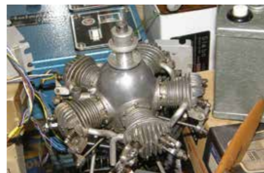
5-Zylinder Stern-Viertakt-Motor Morton M 5 aus den USA, 15 cm 3 , Baujahr 1948
