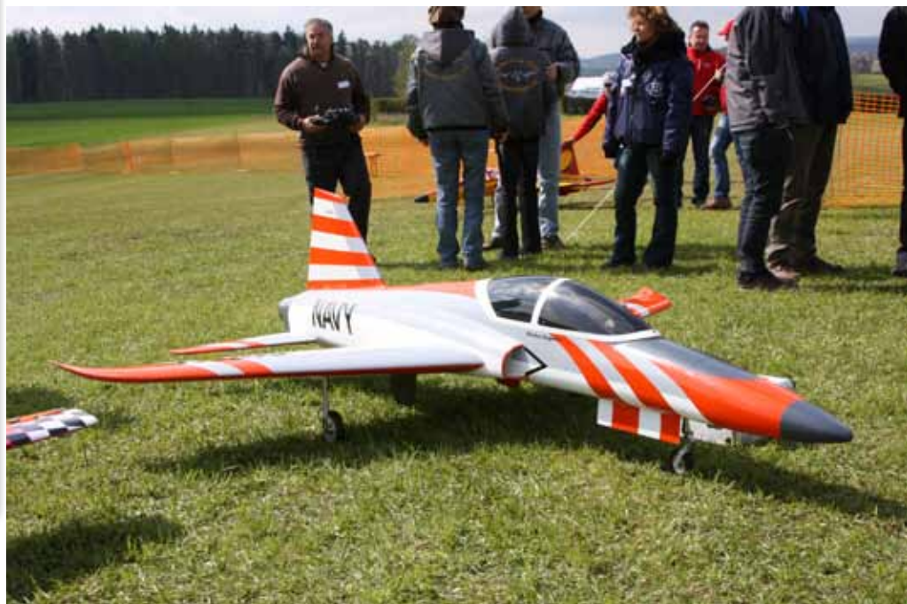
Markus Zippers Ultra Lightning war das heißeste Eisen am Platz, denn sie schafft bei Vollgas schon mal die Marke von 500 km/h . Eine Jetcat P200 Turbine verleiht dem Modell diese hohe Geschwindigkeit. Spannweite: 2300 mm, Länge 2700 mm
