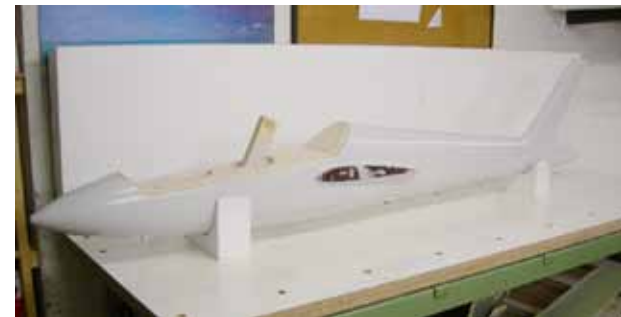
Rumpfmodell nach dem letzten Schleif- und Polierdurchgang, bereit zum abformen.
