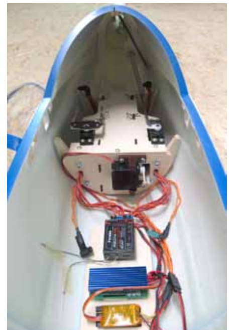
Blick in den fertigen Rumpf. Vorne am Spant das Servo für das Einziehfahrwerk, darüber Höhen- und Seitenruderservo.
