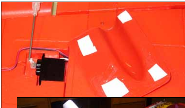
Nach der Montage der mitgelieferten Steuergestänge erfolgte die Abdeckung des Servos mit entsprechenden Abdeckungen.
