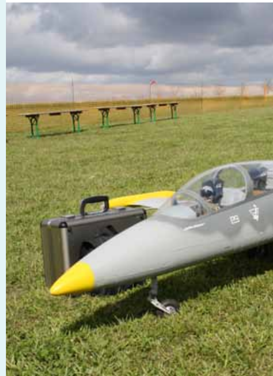
Auch diese Aero L39 Albatros von Airworld kon Sie liegt sehr gut in der Luft und lässt sich aus Daten: Spannweite 1900mm, Länge 2450mm,
