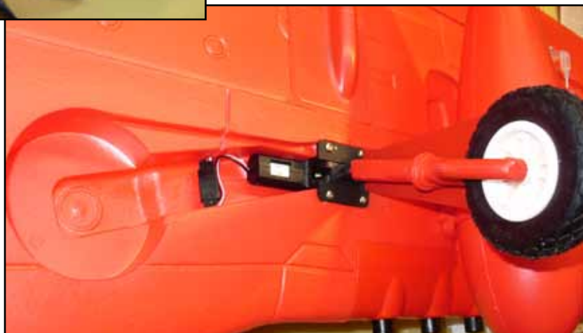
Das elektrische Einziehfahrwerk für das Hauptfahrwerk wirkt sehr robust und arbeitet zuverlässig.
