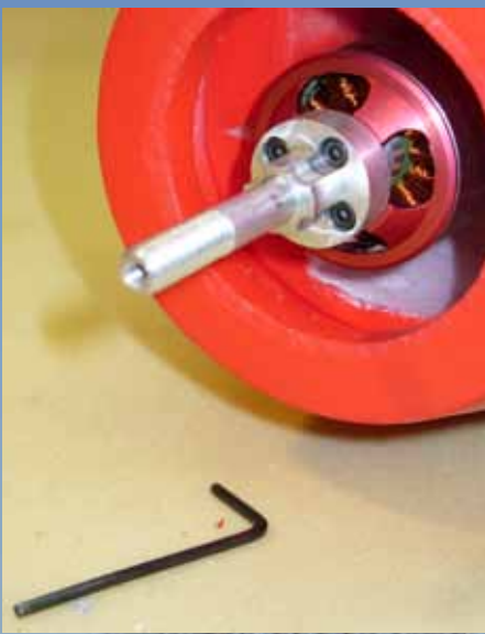
Die Luftschrauben-Kupplung wird mit vier Schrauben an die Stirnseite des Antriebsmotors befestigt.
