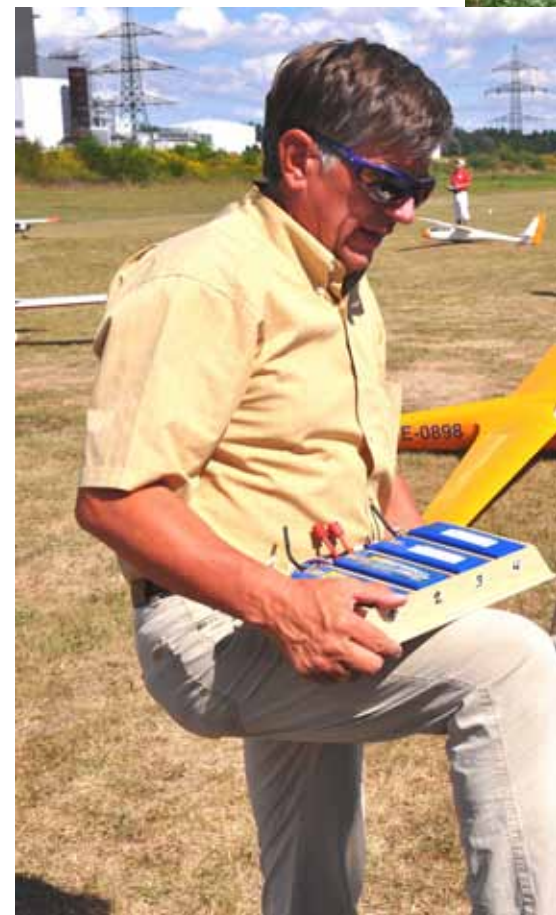
Ein Akkusatz für den Swiss Trainer 12S 2p (4 x 6s 4500mAh)
