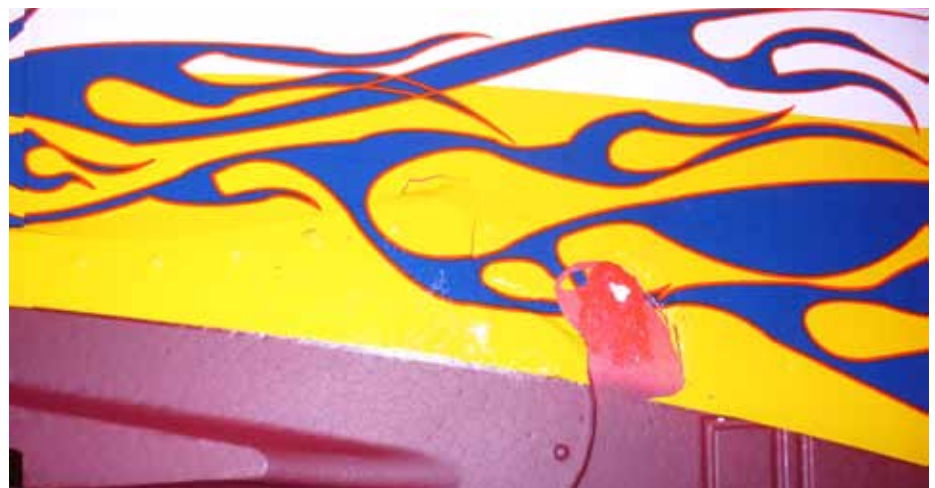
Leider löste sich bei der Testmaschine der Dekorbogen schon beim Auspacken. Als Gegenmaßnahme bekam der Rumpf und das Seitenleitwerk einen Überzug mit Klarlack.
