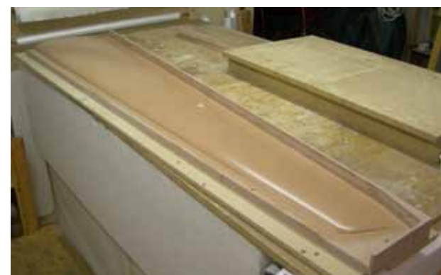
Die Oberseite der linken Tragfläche. Fertig geschliffen, poliert und mit 10 Trennwachs Schichten versehen.
