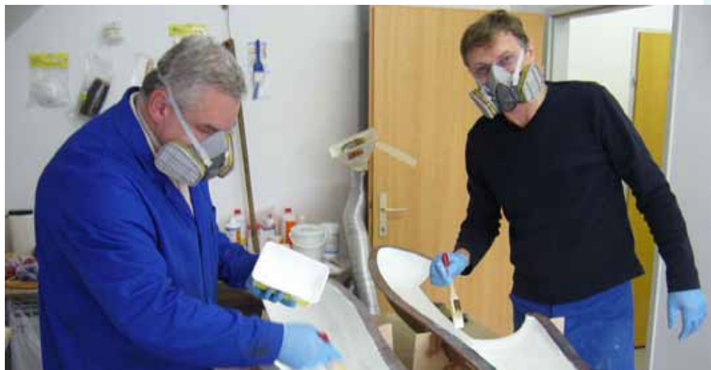
Gelcoat aufbringen mit Atemschutz
