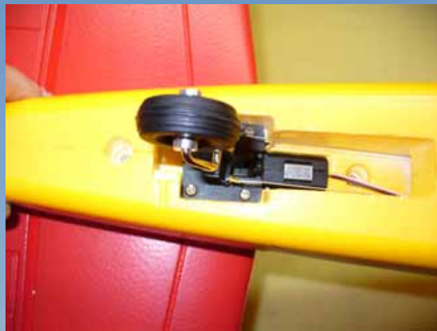
Ansicht des lenkbaren Spornfahrwerks und den beiden 3x50mm Schrauben zur Befestigung des Seitenleitwerks.
