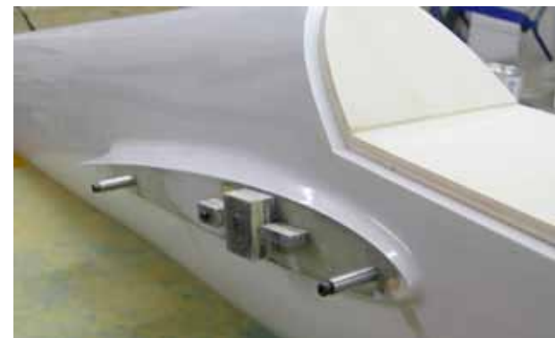
Detail der Wurzelrippe. Vor dem Formenbau werden die Ein-sätze für Passstifte, Kabeldurchführung und Flächenverbinder montiert, die dann bei der Herstellung des Rumpfes die fertigen Öffnungen ergeben.
