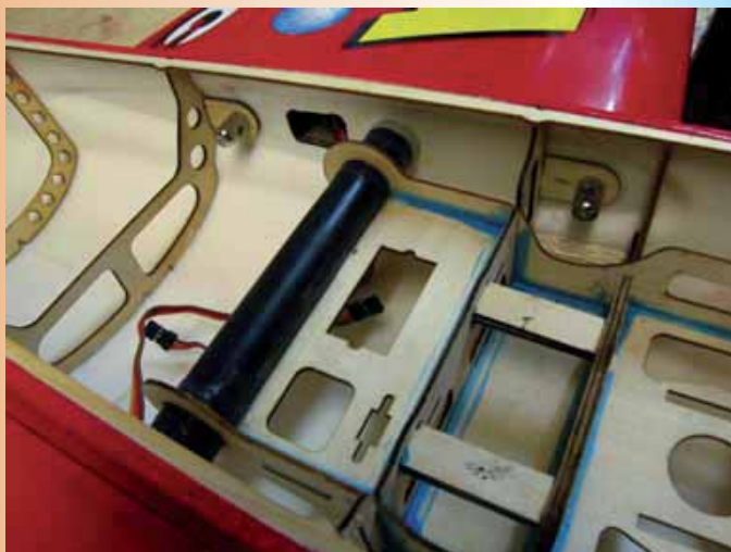
CFK Flächenaufnahme und Flächenverschraubung
