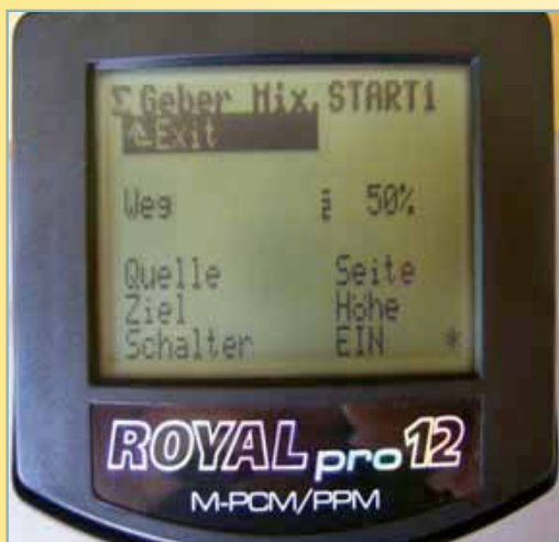
Messerflugmischer. Der neue Punkt GEBER MIX mit dem Beispiel 50% HR Mitnahme mit dem SR für Messerflug für die Flugphase 2.
