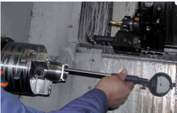
Fertigung Zylinder auf 3-Achs-Drehmaschine Fotos J. Kolm
