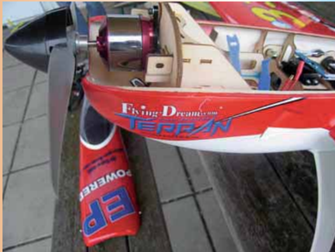
Motoreinbau des sehr kräftigen A4120/7
