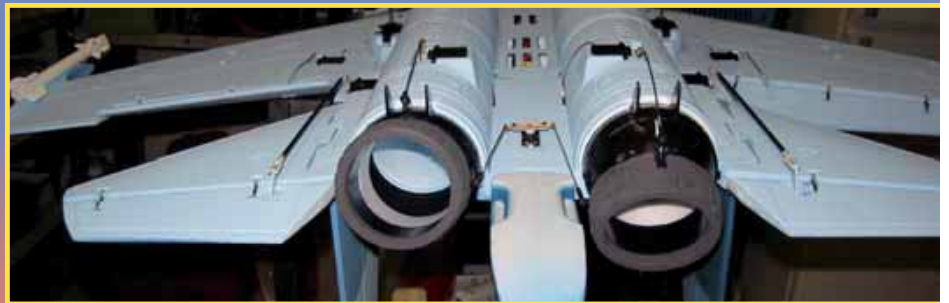
Schubvektorsteuerung bei Querruder links
