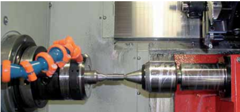
Fertigung Kurbelwelle auf 3-Achs-Drehmaschine
