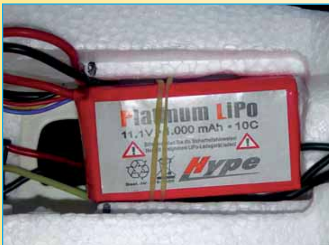
Der Akku mit der nachzubessernden Befestigung (nur ein Gummiring) Die bei der RTF-Version beiliegende RC-Anlage
