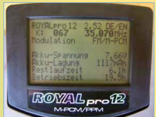
So sieht es jetzt aus. Neu sind die neuen bleibenden Einstellmöglichkeiten für Selbstentladung und Akkukapazität.
