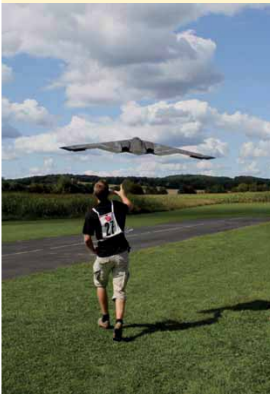
B 2 Spirit Stealth Bomber von Wolfgang Vallant, Spwte. 2,1 m, 1,5 kg, Akku 3s, 5 Ah, gesteuert über Spreizklappen
