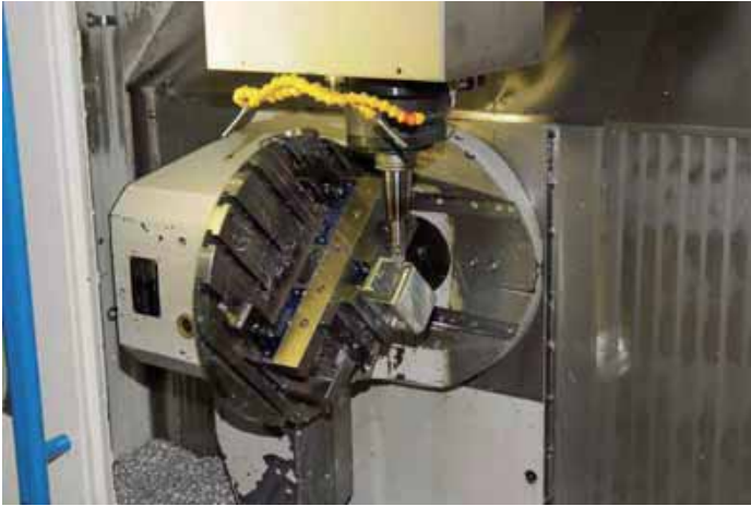
Fertigung Kurbelgehäuse für Boxermotor auf 5-Achs -Fräsmaschine
