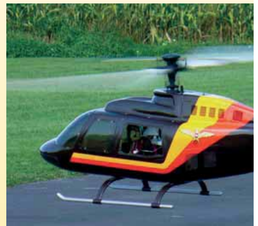
JetRanger, umgebaut vom Verbrenner zum Elektro
