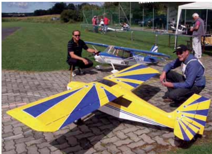
Kurt Winkelbauer mit Bellanca, Spwte. 3,4 m, 16 kg, Akku 12s, 10 Ah, rechts Ernst Straka, Super Decathlon, Spwte. 3 m, 13 kg, Akku 14s, 4,9 Ah
