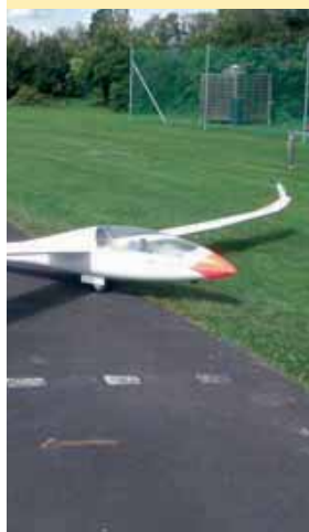
Rudolf Aita, Duo Discus, Klapptriebwerk, Spwte. 8 m, 24,9 kg, Akku 5s2p, 10 Ah
