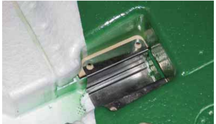
Verstärkung der Fahrwerksaufnahme mit Stahlprofil
