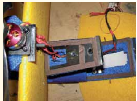
Der Regler wurde in den Pylon eingebaut. Bei der Tragflächenauflage und im Bereich der Kabinenhaube wurden zusätzlich Dichtungen aufgeklebt.
