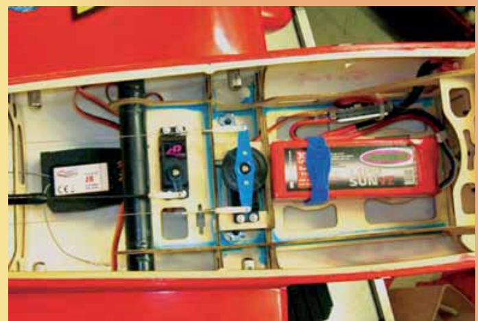
Alles eingebaut im geräumigen Rumpf der Extra
