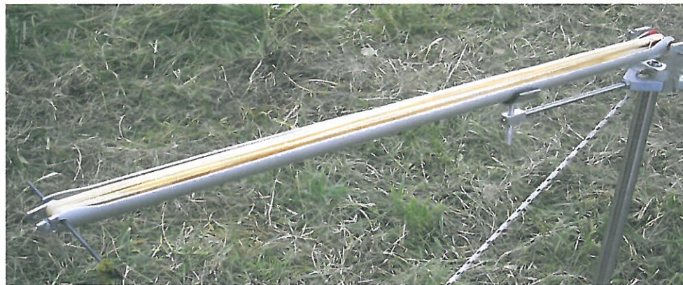
In dieser U-Schiene wird der Gummi außerhalb des Modells aufgezoogen, und dann erst ins Modell eingeführt.
