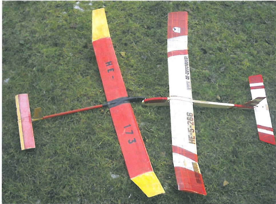
2 einfache Modelle der Klasse F1H – links ein Wettbewerbsmodell in Standard-Bauweise, rechts ein Anfängermodell konventionell.
