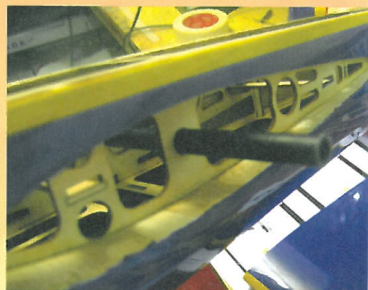
der CFK-Holm passt genau
