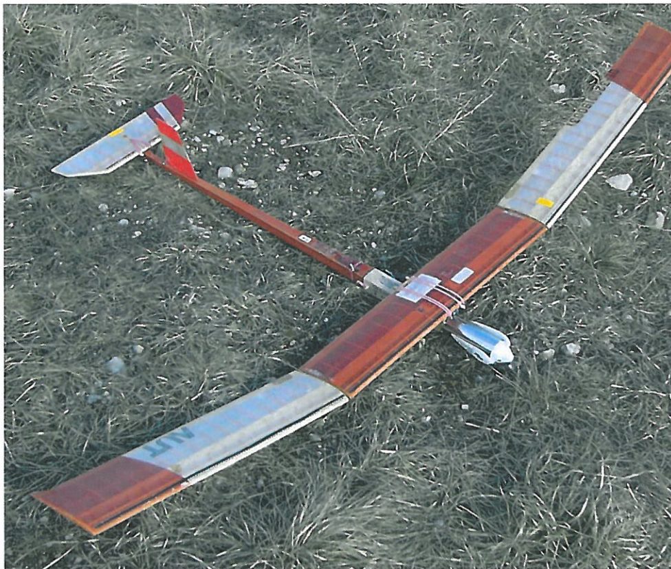
Ein von einem F1B-Modell abgeleitetes Experiment in der neuen Klasse F1Q mit Elektroantrieb.
