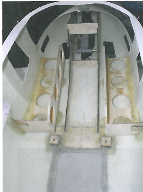
Draufsicht für Akku-Spannen und Bugfahrwerk.
