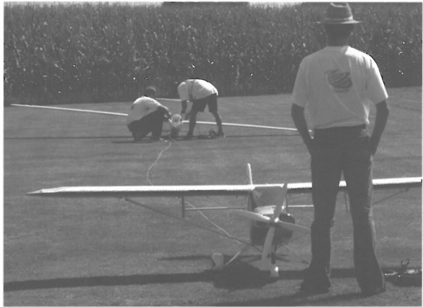
Das Team Markus Gruber(Sohn)/Alfred Gruber(Vater) kamen mit einer echten Überraschung zur ÖM. Die schon länger bekannte Red Bull Piper zog eine neue DG-1000 der Superlative. 6 Meter Spannweite und nur 8,42 kg Gewicht. Diese Extreme waren nur durch CFK-Bauweise möglich. Die Tragflügel sind holmlose Styrokerne, die mit einem plattenförmigen Kohlelaminat beplankt wurden.
