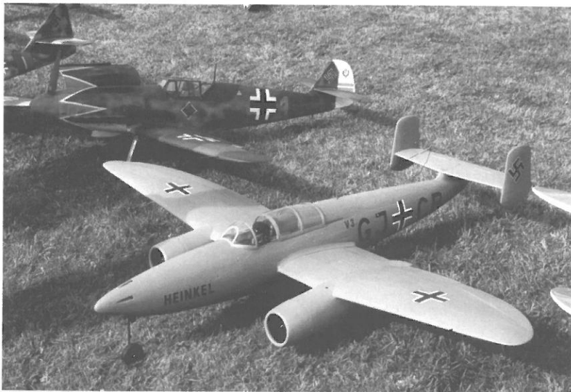
HEINKEL He 280 Impeller, 6kg, 32 Zellen dahinter Me 109, 6kg, 2m Spannweite, 36 Zellen.
