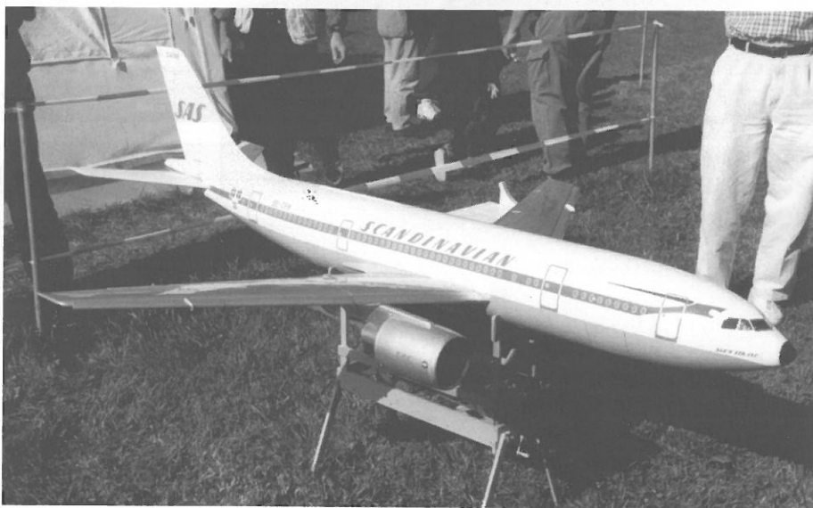
AIRBUS A300 mit E-Impeller, 5,6 kg, 28 Zellen, 1,87m Spannweite.
