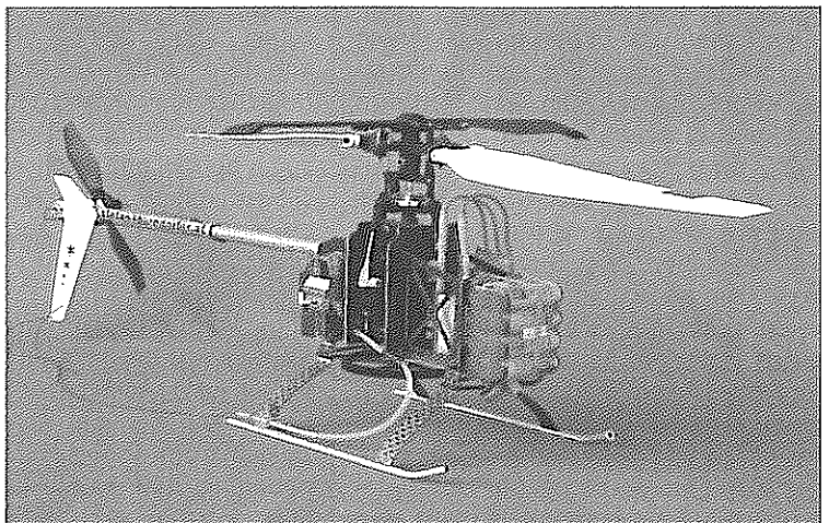
LMH 110-E mit CFK-Chassis und Brushlessantrieb
